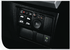
สวิตช์ควบคุมประตูสไลด์อัตโนมัติ ซ้าย-ขวา ด้านคนขับ
