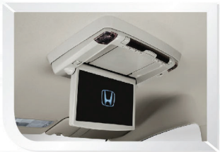
เครื่องเล่นดีวีดี พร้อมจอ LCD ขนาด 10 นิ้ว สำหรับพู่โดยสารตอนหลัง
